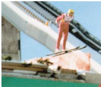
Enregistrement des forces exercées sous les skis du sauteur lors de son envol, grâce à des plaques fixées sur l'aire d'envol. (Calgary 1988).
