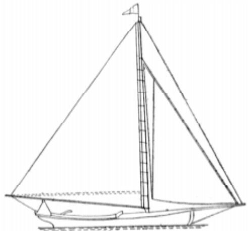
Leg-of-mutton Rig. Fig. 4.
